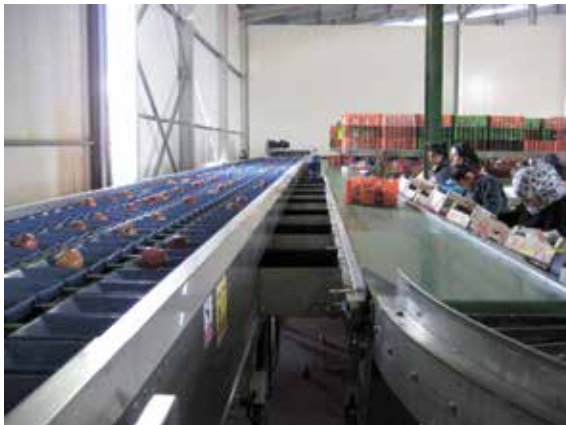
מכונות מיון של עשת אילון. ממיינות את התוצרת לפי צבע, גודל, קוטר ומרקם
